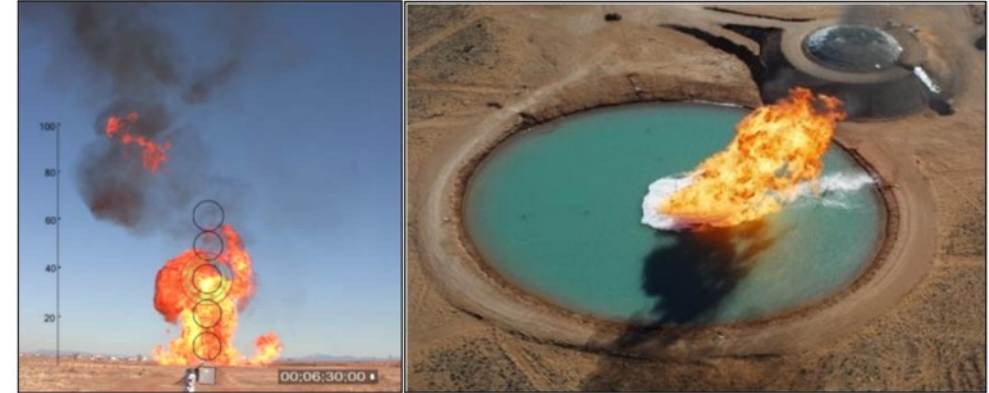
Figure 7. LNG Test 2 – 83 m diameter LNG spill and pool fire.
